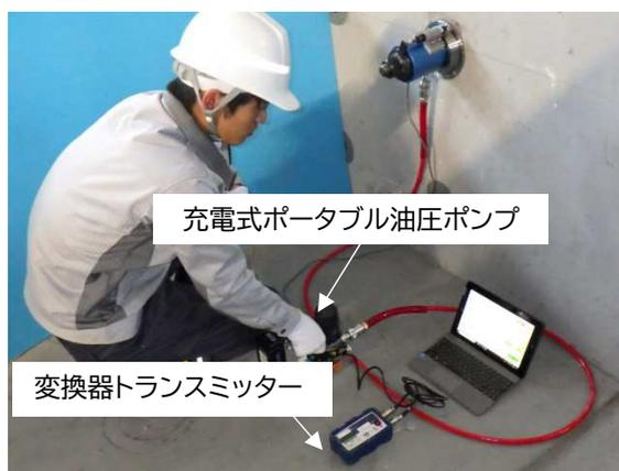
③充電式ポータブル油圧ポンプ、変換器トランスミッター専用タブレットをセットし計測を開始します。
