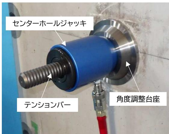
①センターホールジャッキ、テンションバー、角度調整台座、テンションバーナットをセットします。
