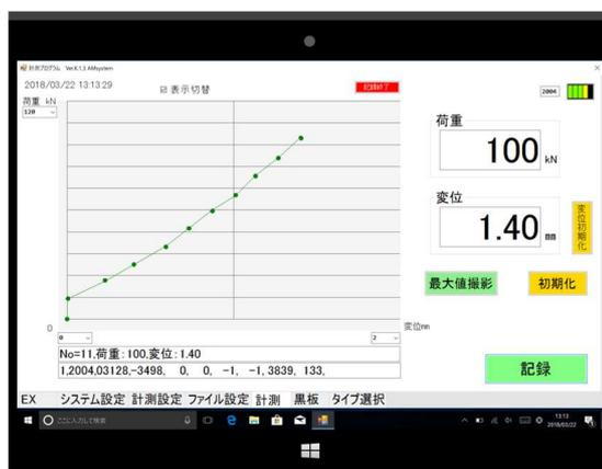
④载荷試験中にリアルタイムで荷重・変位関係を確認することができます。
